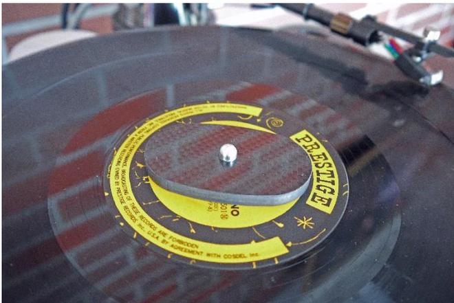
こちらのスタビライザーをレコード盤の上に設置するだけでももちろん良いのですが、CFRP はインシュレーターとしても非常に優れていることから、ご愛用の重量級スタビライザーとレコードの間に設置するスペーサーとしても活用する事が出来ます。
